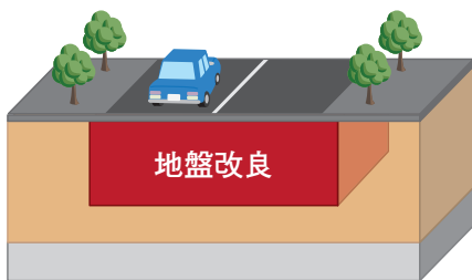
道路の沈下防止
